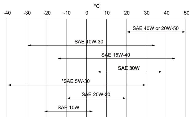
\* Может использоваться только в том случае, если имеется для данного класса дизельного двигателя. При использовании синтетического масла следуйте рекомендациям изготовителя масла.
